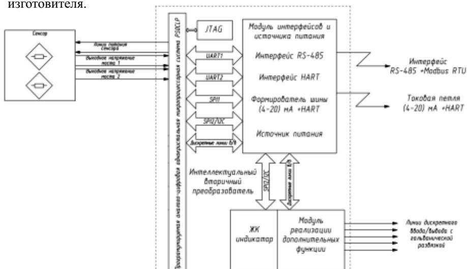
Рисунок 2 - Блок-схема датчика
