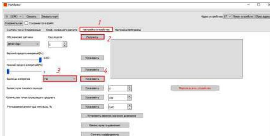
Рисунок 8 – Окно программы при установке единиц измерений
