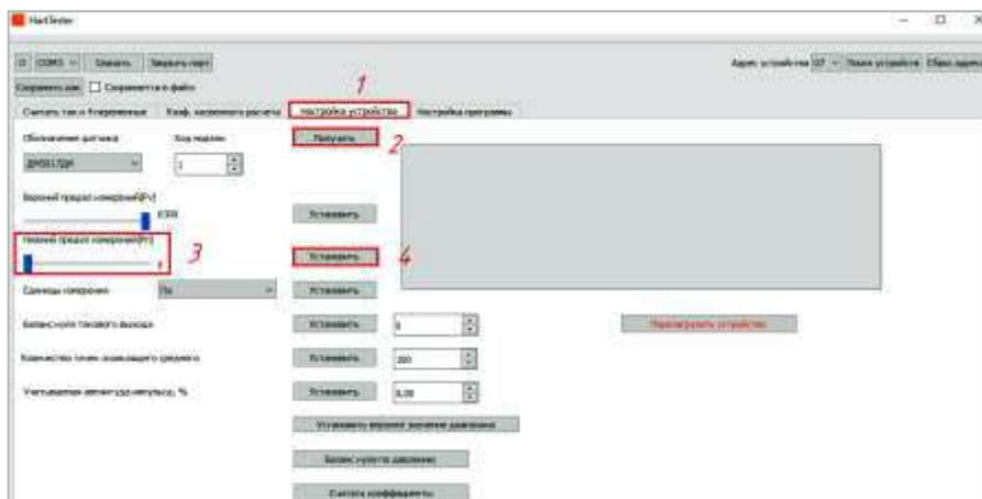
Рисунок 7 – Окно программы при установке нижнего предела измерений
