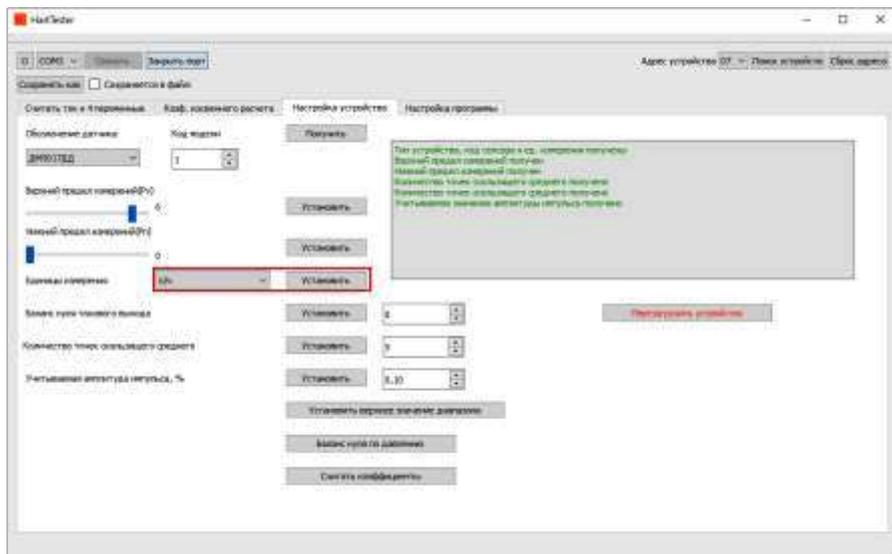
Рисунок 38 – Настройка ДМ5017-Вн в программном комплексе HartTester
