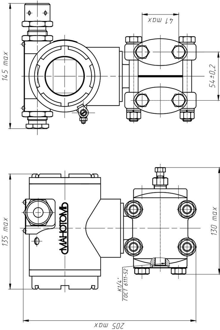
Рисунок Б.1 – Габаритные и присоединительные размеры датчиков
