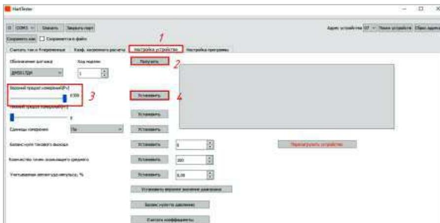
Рисунок 6 – Окно программы при установке верхнего предела измерений
