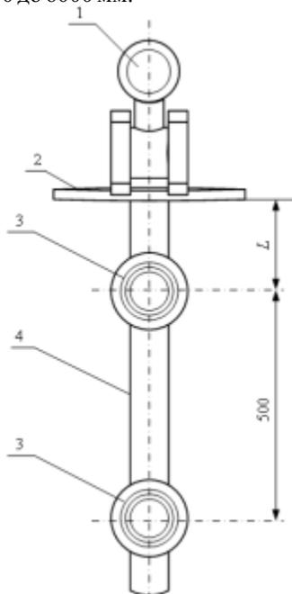
Рисунок 37 – Система измерений плотности жидкости в резервуарах
