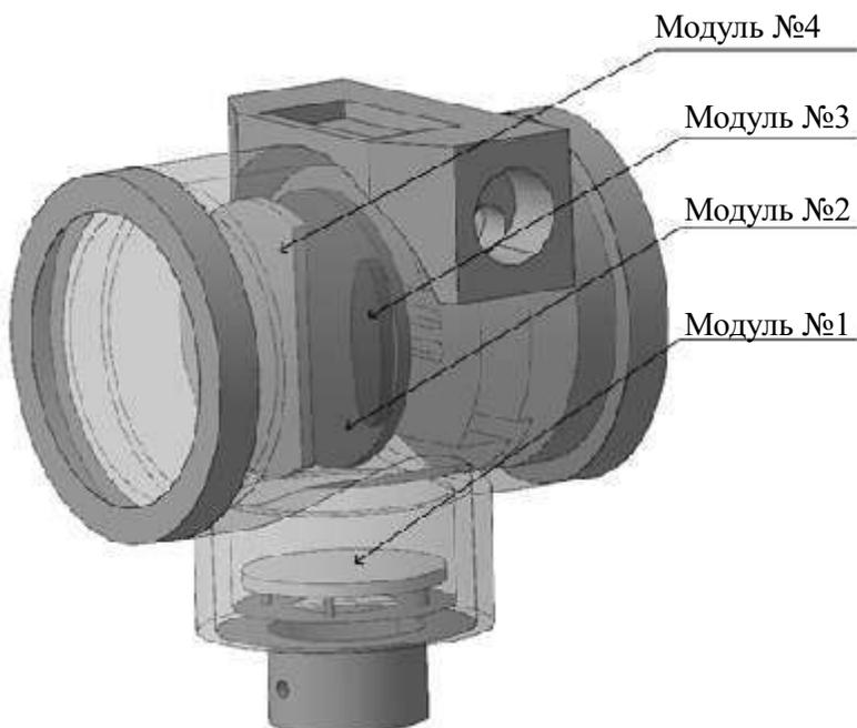
Рисунок 3 - Расположение модулей электроники в корпусе датчика
