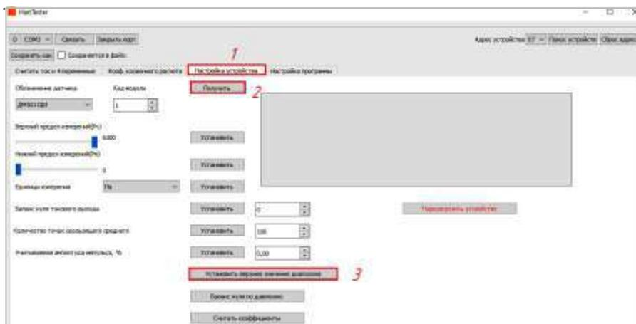
Рисунок 13 – Окно программы при установке верхнего значения диапазона
